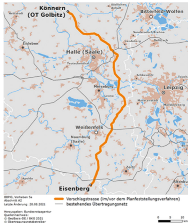
Abbildung 8: Trassenverlaufsplanung SuedOstLink Quelle: Bundesnetzagentur (2021)
