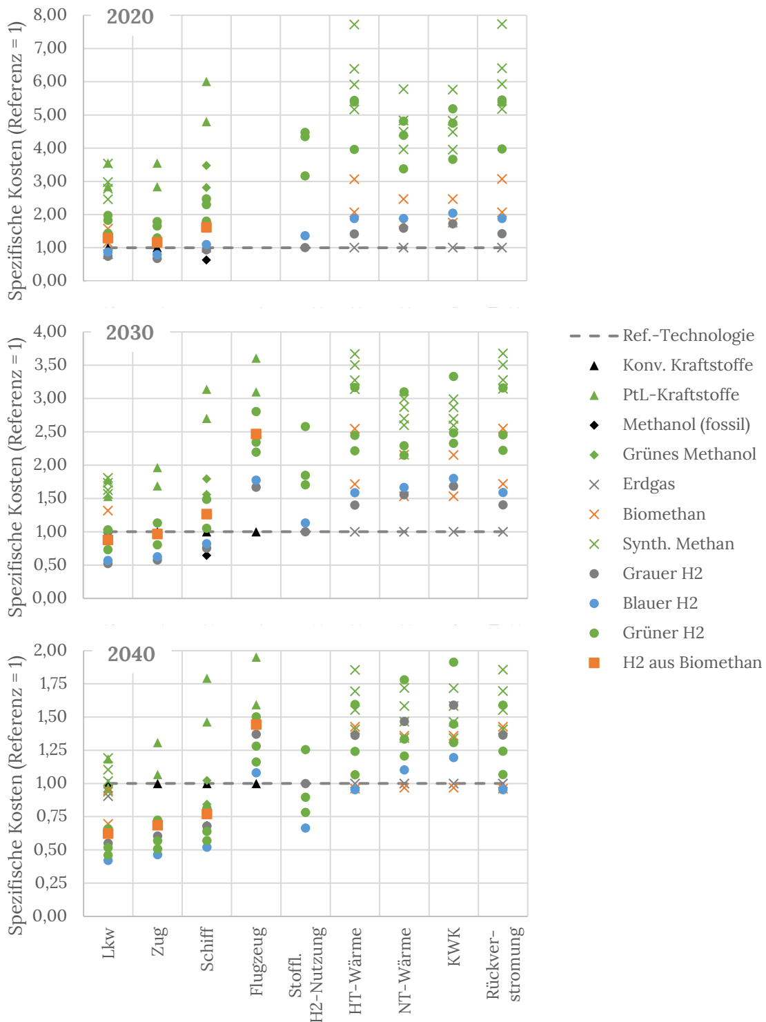
Abbildung 3: Übersicht der ermittelten spezifischen Kosten in den jeweiligen Anwendungsfeldern für die betrachteten Zeithorizonte (Darstellung erfolgt im Vergleich zur jeweiligen Referenztechnologie mit Indexwert = 1)
