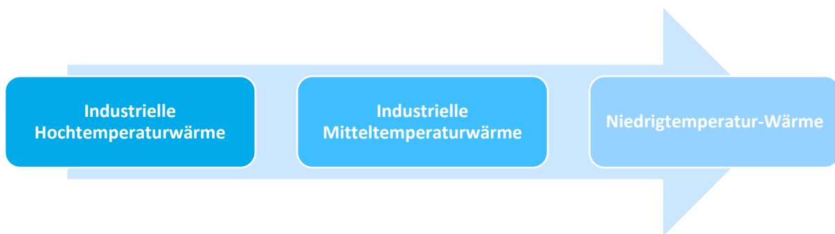
Abbildung 4-11: Kaskadennutzung verschiedener Temperaturniveaus (Quelle: Eigene Darstellung)
