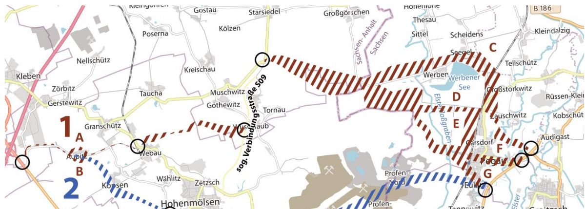
Abbildung 22: Untersuchte Grobkorridorvarianten (Ausschnitt) – Einbeziehung des Teilstücks 1-D in die Vorzugsvariante (Grafik: W&D)
