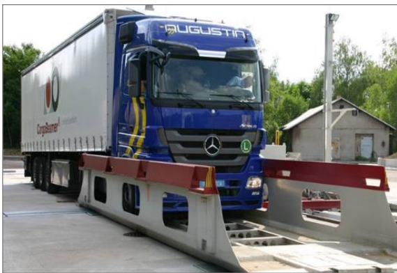
Abbildung 44: Lkw-Einfahrt und vertikales Kranumschlagsystem CargoBeamer 153
