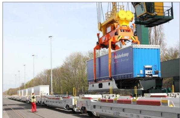
Abbildung 44: Lkw-Einfahrt und vertikales Kranumschlagsystem CargoBeamer 153
