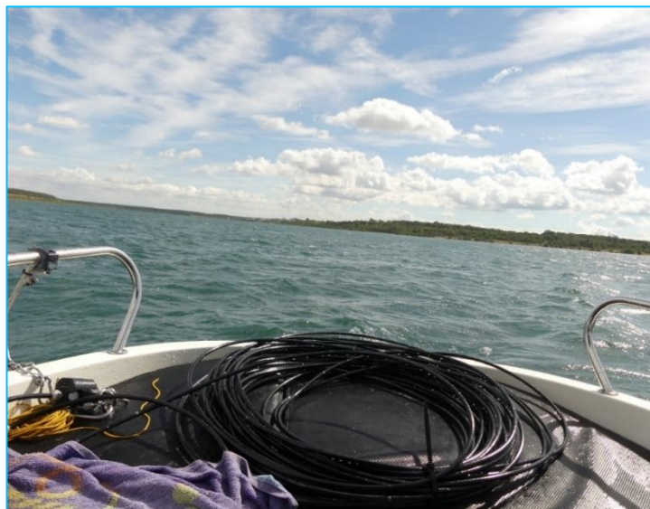
Abbildung 40: Manuelle Aufnahme von Temperatur-tiefenprofilen
