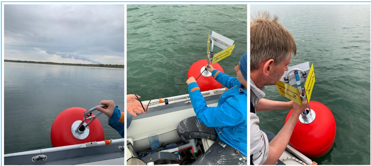
Abbildung 38: Setzen der Boje, Einfädeln der Temperaturmesskette; Installation des Datenloggers und der Funkübertragungseinheit
